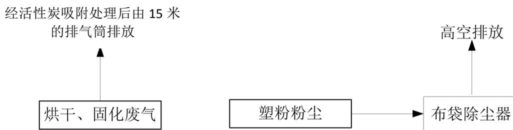
图 2-4 喷塑车间废气处理工艺流程图
